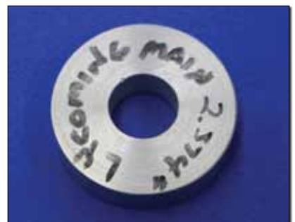
Fig. 14: Crank journal gauge plug.
